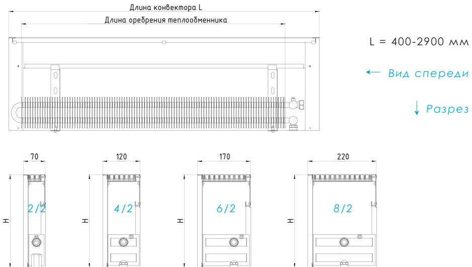
Настенный конвектор SPL Basic WM высота H мм ширина 70-220 мм
